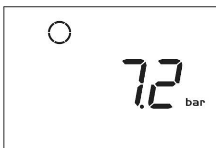
Основной экран с показателем давления (остановленный компрессор)
